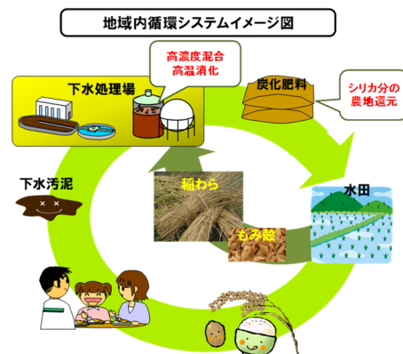
図3 下水汚泥と稲わらの高濃度高温混合メタン発酵を核とした地域循環システム
